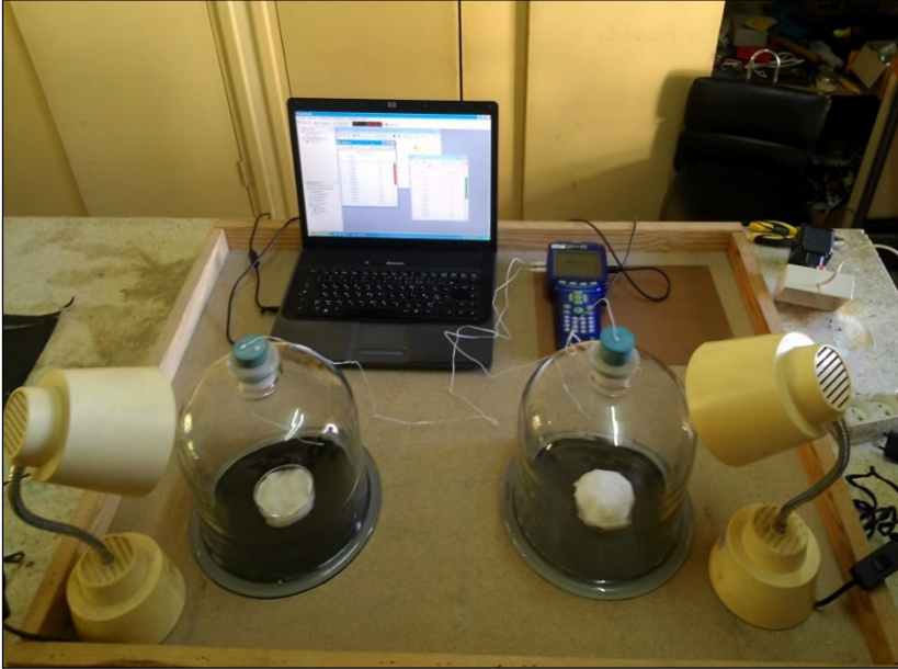
Figure 1 : Expérience réalisée dans un environnement de laboratoire ExAO sur l'effet de serre au lycée Ibnou Roched- Fès
